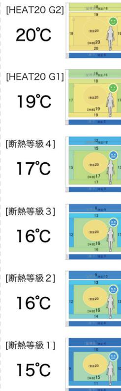
断熱性能の基準は、国が定めた基準と、有識者が集まって決めたものがあります。断熱等級 1 ~ 4 が国の定めたもので、HEAT20という有識者が集まって作った団体が提示した基準が、HEAT20のG1、G2というグレードです。これらの基準値のとき、体感温度がどうなるか示します。上の図は、一年で一番寒かった日の翌日の朝、寝ている間は暖房を切って、起きる1時間前にエアコンで暖房して、起床した時の室温と壁の温度、そのときの体感温度をシミュレーションしています。
