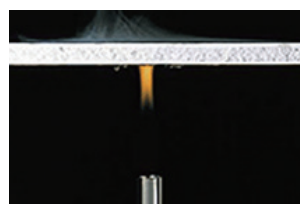
▲水蒸気を発生する石膏ボード
