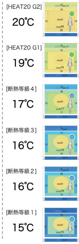
断熱性能の基準は、国が定めた基準と、有識者が集まって決めたものがあります。断熱等級 1～4 が国の定めたもので、HEAT20という有識者が集まって作った団体が提示した基準が、HEAT20のG1、G2というグレードです。これらの基準値のとき、体感温度がどうなるか示します。上の図は、一年で一番寒かった日の翌日の朝、寝ている間は暖房を切って、起きる1時間前にエアコンで暖房して、起床した時の室温と壁の温度、そのときの体感温度をシミュレーションしています。
