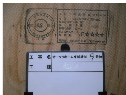
■28ミリの構造用合板の断面
